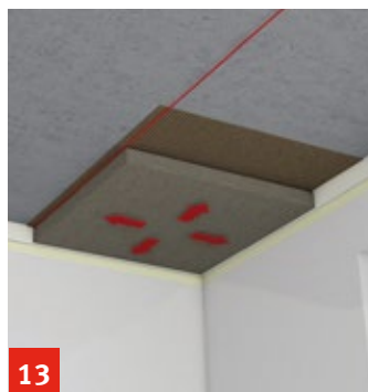
13. Platte einschwimmen und anpressen
