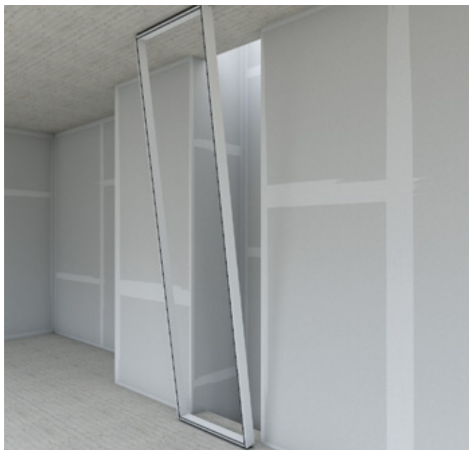
Installation du cadre
