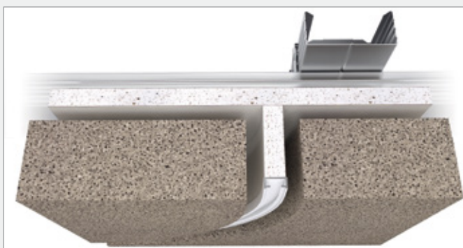
Courbe à deux voies, forme en L, Système acoustique REAPOR 50 mm *
