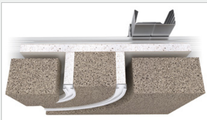
Courbe à deux voies, forme en U, Système acoustique REAPOR 50 mm *
