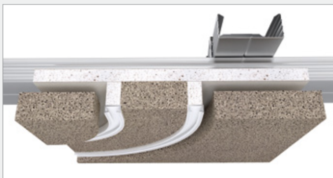
Courbe à deux voies, forme en U, Système acoustique REAPOR 24.5 mm *
