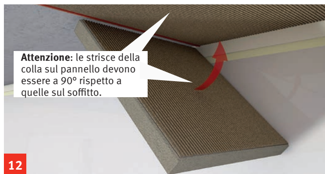
12. Posizionare il pannello sulla linea, incollare con la tecnica del floating buttering
