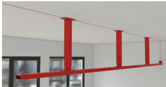
Unterrohr in Wandadapter einschieben und mit Bohrkopfschrauben an der Abhangstütze verschrauben
