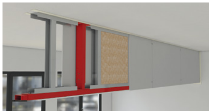
1. Lage auf der Rückseite montieren, Dämmstoff einbauen, 1. Lage auf der Außenseite und der Untersicht anbringen
